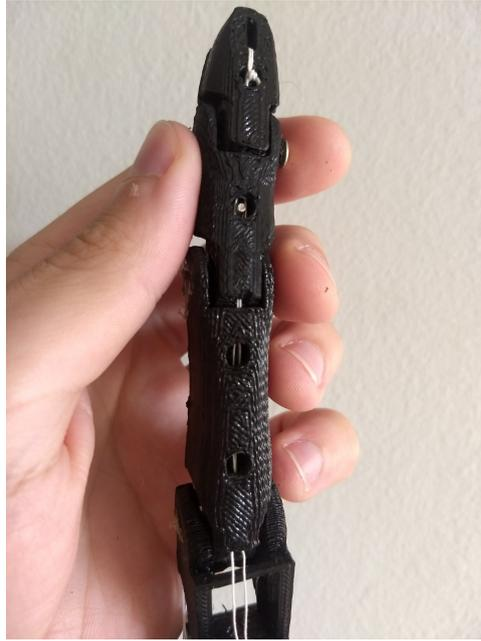
**Figura 19: Dedo da mão robótica construído com as linhas. Fonte: autoria própria**
